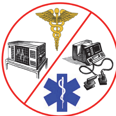
Figure 2-7 Charges qui devraient ne jamais être employées avec le PowerHub 1800
