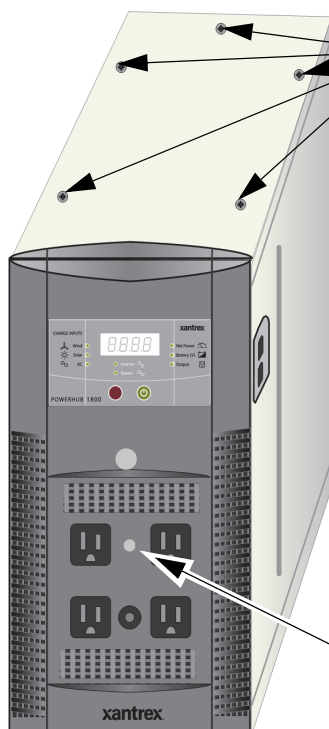
Figure 3-22 Remplacement du fusible de protection contre les fuites à la terre
